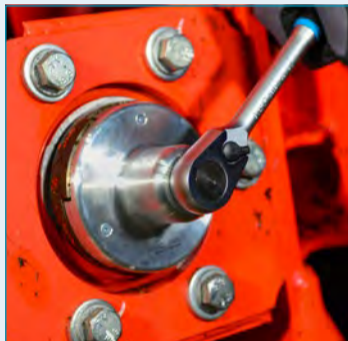
Betätigung mittels Knarre durch eingebrachte 12,5 mm (1/2") 4kt.-Aufnahme
