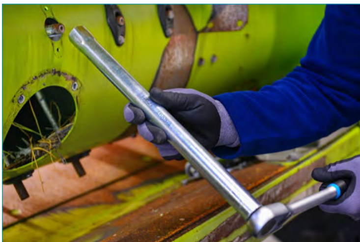
Betätigung mittels Knarre durch eingebrachte 12,5 mm (1/2") 4kt.-Aufnahme
