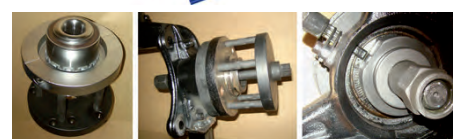
Préparation du montage roulement 72 mm, dépose roulement 85 mm (côté moyeu), dépose roulement 85 mm (arrière)
