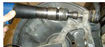
Chasser l'embout de biellette (avec n° 8760)
